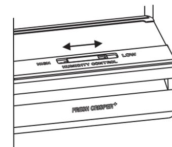
Овощной ящик с функцией регулирования влажности **Humidity**. Регулирование осуществляется перемещением заслонки: влево - для небольшого количества продуктов и повышения влажности; вправо - для большего количества продуктов и снижения влажности.
