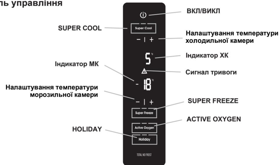
**ВКЛ/ВИКЛ** - натисканням цієї кнопки можна включити весь прилад в цілому (як холодильну, так і морозильну камери). Для відключення холодильника достатньо натиснути і утримувати протягом 3 секунд кнопку, холодильник вимкнеться із затримкою 6 секунд.
