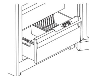
**Super Freeze +70°C -18°C.** Это функция быстрого замораживания в специальном контейнере нижнего ящика морозильного отделения. Только что приготовленные мясо, рыба (до 1 кг) при температуре 70°C помещаются в центре контейнера и за 6 часов замораживаются до -18°C, это позволяет свести к минимуму развитие бактерий и повышает качество продукта. Не забудьте отключить функцию Super Freeze.
